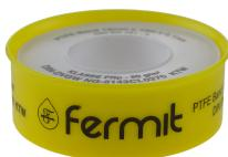
FRP traka za brtvljenje navoja (FINE THREAD) je namotana u smjeru kazaljke na satu za desni navoj i suprotno od kazaljke na satu za lijeve navoje od kraja navoja u smjeru kraja cijevi i sa 50% preklapanjem navoja: Na kraju od konca, traka se jednostavno otkine i pritisne. Tokom naknadnog procesa zavrtanja, FRP navojna traka čvrsto leži u pojedinačnim navojima. Traka s navojem namijenjena je za jednokratnu upotrebu. Prepusti ili krajevi trake ne smiju viriti u cijevi.
